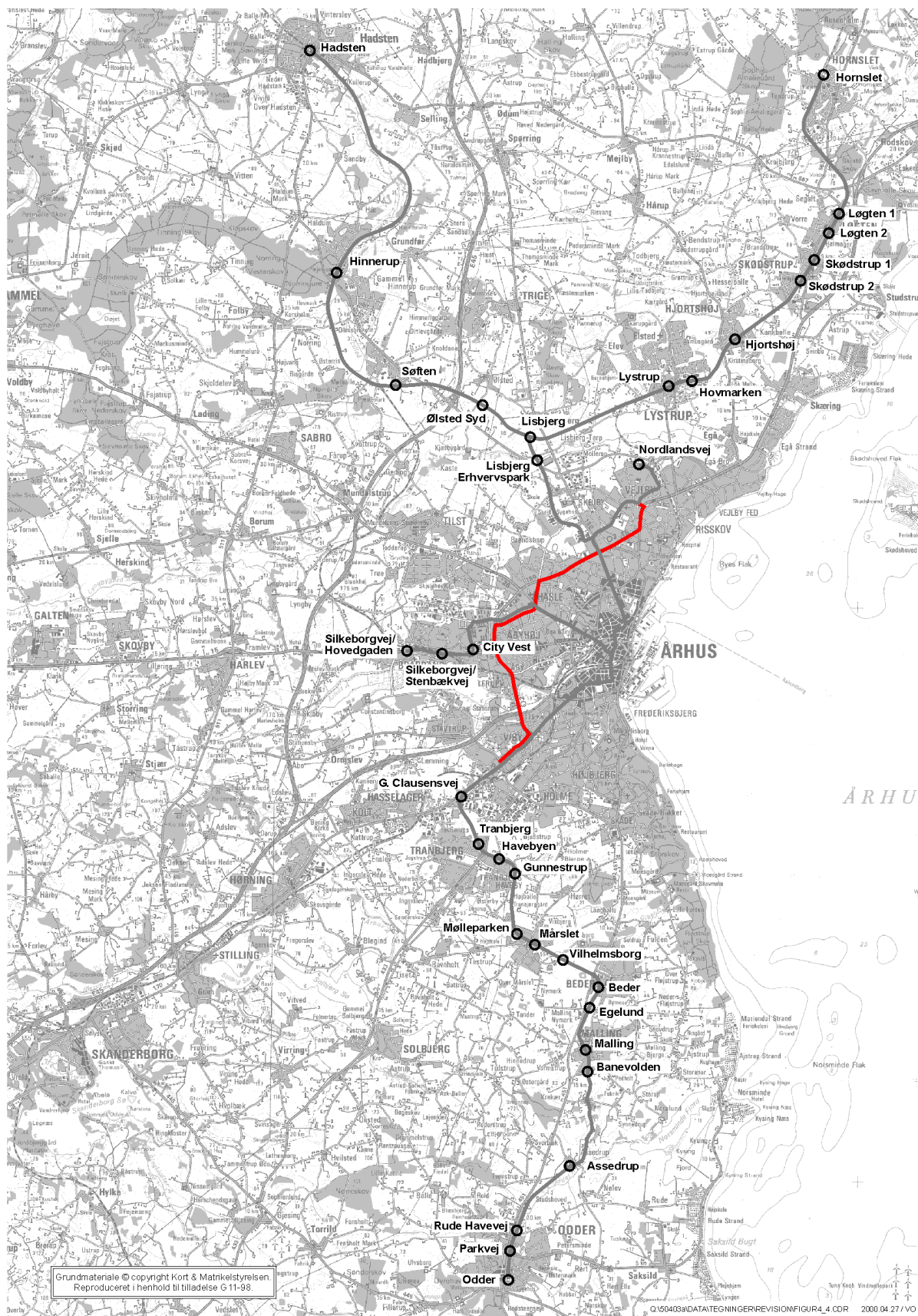
Figur 3. Sporvognsløsning (17) med udvidet grundnet med nærbaner og hovedbane. Stoppsteder på inderstrækningerne, se Figur 1. Ringlinien er betjent af busser på egen tracé.
