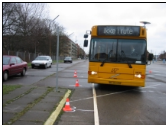
Figur 4. Ved indkørsel til kantsten skal bussens forende ind over "fortovet" (markeret med lægte) for at bagenden senere i manøvren kan komme ind til "kantstenen". Ellers får passagererne dårlige udstigningsforhold, hvilket især rammer ældre og gangbesværede. Jo kortere afstand der er i bussens kørselsretning til at foretage manøvren desto mere bredde og indsving over fortov kræves for at manøvren kan lykkes.
