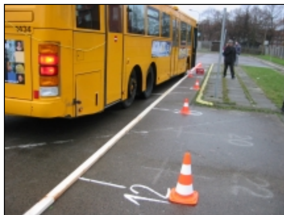
Figur 4. Ved indkørsel til kantsten skal bussens forende ind over "fortovet" (markeret med lægte) for at bagenden senere i manøvren kan komme ind til "kantstenen". Ellers får passagererne dårlige udstigningsforhold, hvilket især rammer ældre og gangbesværede. Jo kortere afstand der er i bussens kørselsretning til at foretage manøvren desto mere bredde og indsving over fortov kræves for at manøvren kan lykkes.
