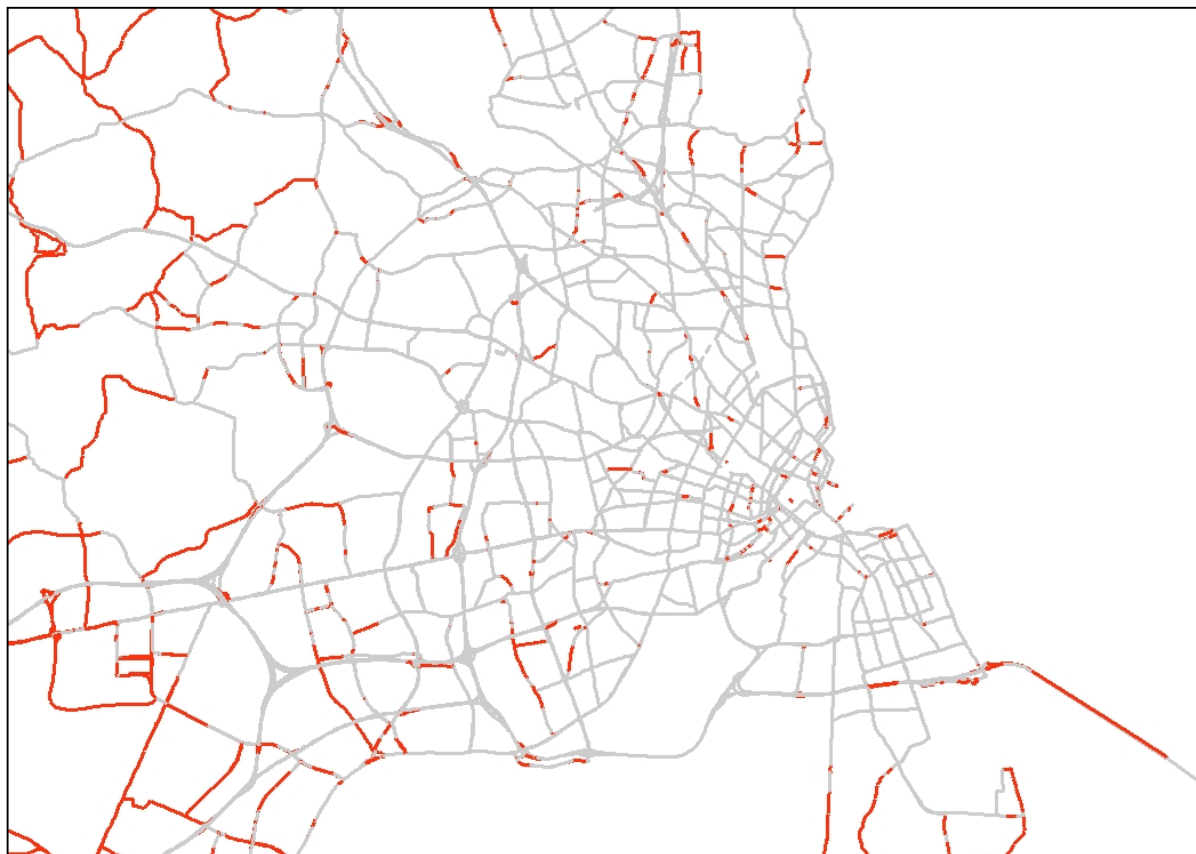
Figur 6. Dækningsgrad på store lokalveje. Veje markeret med rødt har ikke tilstrækkelig dækning (10 gennemløb af mindst 3 forskellige biler). Det bemærkes at deltagerne primært bor og arbejder inden for amtsgrænsen (dvs. i Københavns Amt, eller Frederiksberg og Københavns Kommuner). Inden for dette område er dækningen næsten komplet. Stort set alle Trafikveje (bortset fra Øresundsbroen) er dækket, hvorfor disse ikke er vist.
