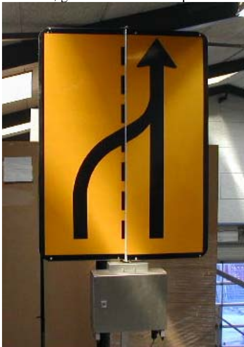
Figur 8 Bruttotypen af den nyudviklede automatiske klaptavle
