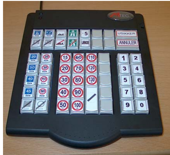
Figur 4 — Specialdesignet keyboard til registrering af hastighedsskilte
