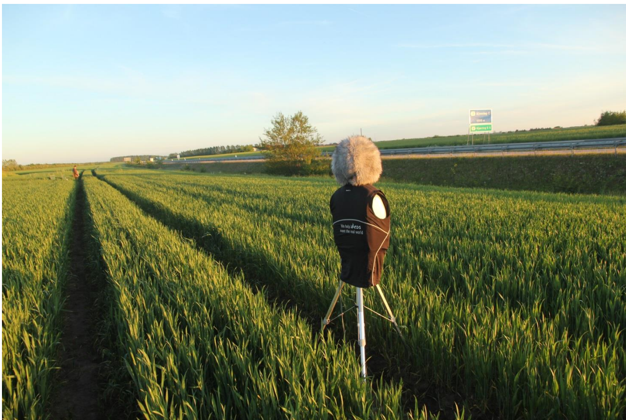
HATS på arbejde ved nordjysk motorvej. Lydoptagelser til auraliseringer foretages ved hjælp af HATS (Head And Torso Simulator).
