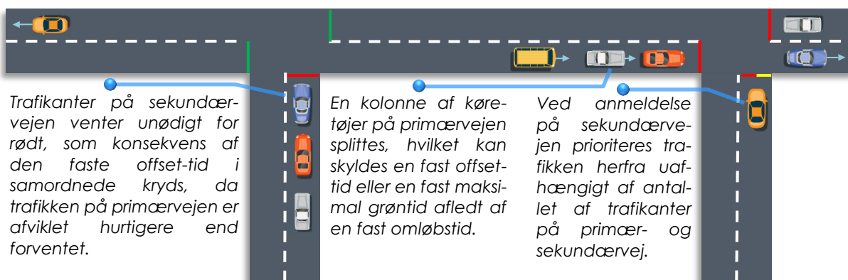
Figur 2: Principskitse, som illustrerer situationer på en strækning med flere samordnede signalanlæg, hvor traditionelle principper, herunder teoretisk beregnede offset-tider samt en fast maksimal grøntid afledt af en fast omløbstid, medvirker til en unødige ventetid for rødt på såvel primær- som sekundærvej.
