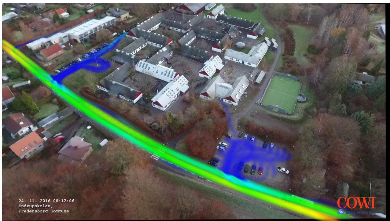
Figur 5: Gennemsnitshastigheder for trafikanten omkring Endrupskolen. Hastighederne er udtrykt ved et heat map.
