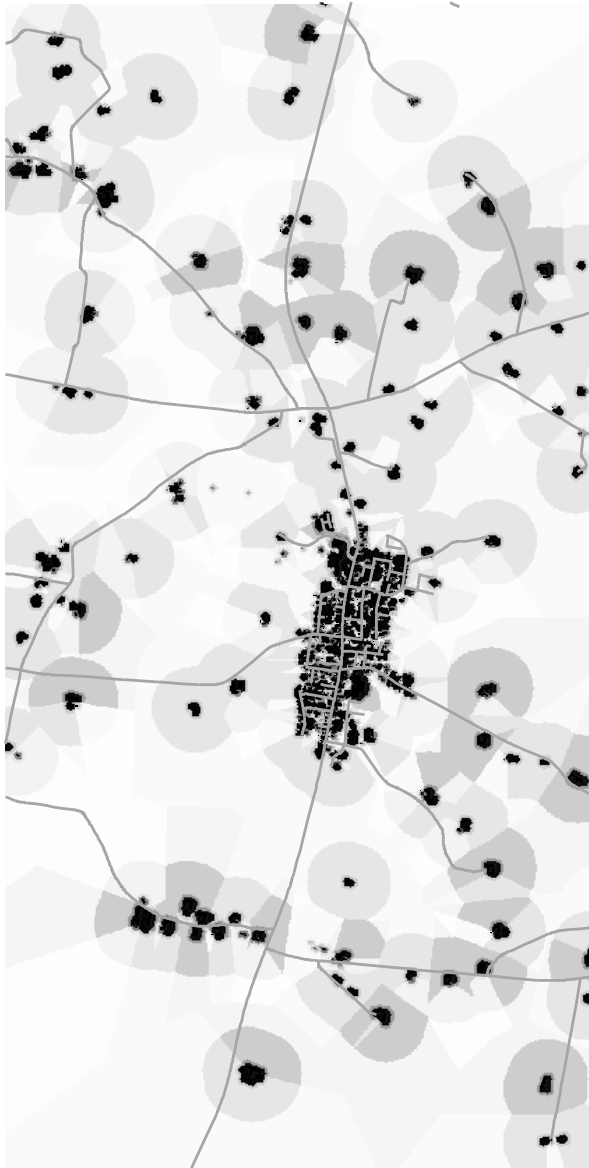
Figur 10. Bygninger klassificeret efter størrelse med angivelse af en zone omkring bygningen. Zonen har ikke som man må formode efter figuren kun en værdi i dens celler, værdien aftager jævnt med øget afstand til bygningen. På grund af manglende farver kan systemet ikke vise det.
