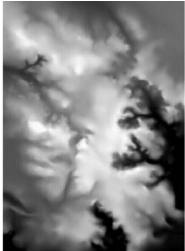
Figur 1. Højdekurver på vektor-form bliver konverteret til et højdebillede.
