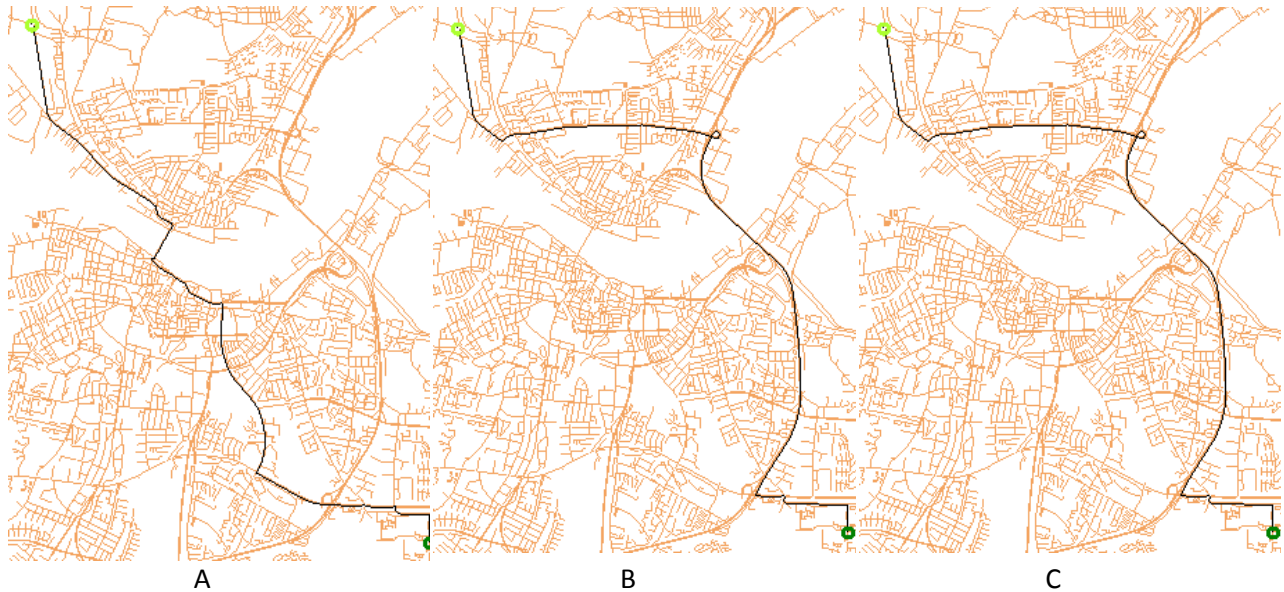
Figur 5: Aalborg Universitet til Aalborg Lufthavn A) Minimal distance B) Minimalt brændstof C) Minimum tid
