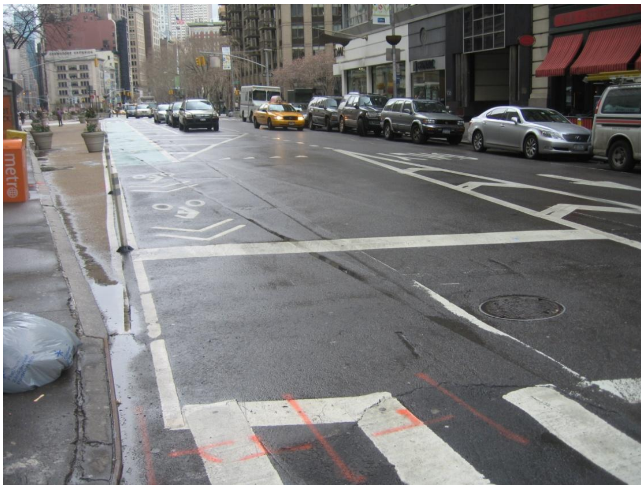
Cykelbanen er afkortet og kombineret med en højresvingsbane – bemærk bufferzonen imellem cykelbanen og de parkerede biler.
